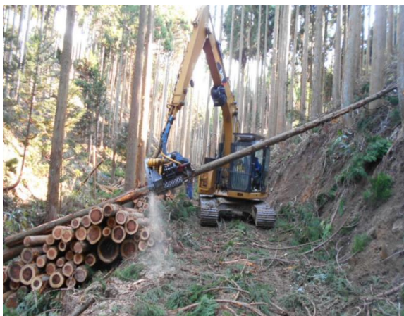
林業機械で立木を伐採し丸太にする作業
